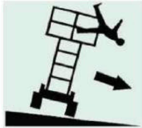
Fig. 2 Vuelco del equipo por falta de estabilidad
