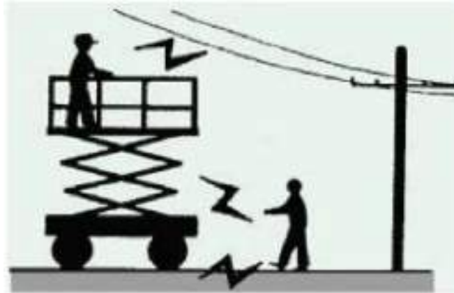
Fig. 5 Contacto eléctrico directo con líneas eléctricas aéreas de AT
